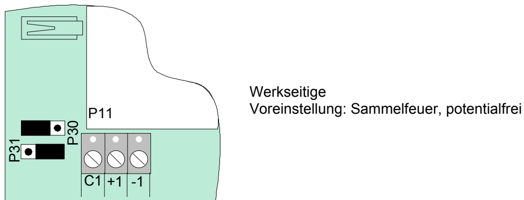
Abb. 8: Lage der Anschlussklemmen des Relais-X und zugehörige Kodierbrücken
