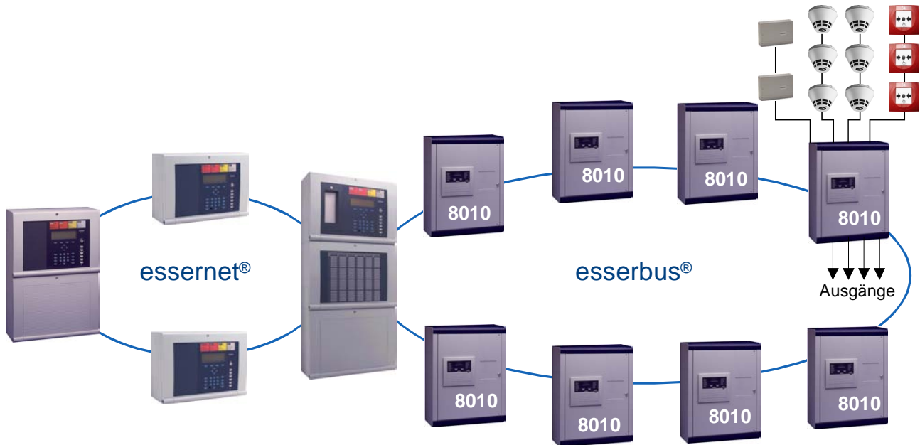
Abb. 37: Löschmittel-Ansteuereinrichtung 8010 im Brandmeldesystem 8000/IQ8Control
