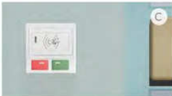
RFID-Modul und Patienten-/Personalkarten dienen individuellen Steuerungsfunktionen
